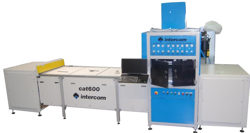
Desplazamiento automatico de los cajones: en esta version estan incluidos 16 cajones(minimo) mm 850x615. Esta configuracion permite al operador el tener ante si 4 cajones, donde poner las piezas, y recojerlas despues que el pegamento ha sido aplicado.
